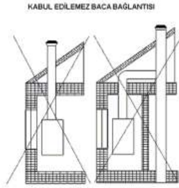
Şekil 33 Çatı arasından bacalı cihaz bacası geçmez
